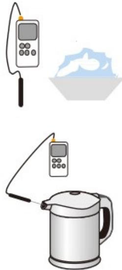
基本的な校正ではありませんが、水道水を汲んだコップに使用している中心温度計を全ていれて、棒温度計との誤差を確認して記録するだけでもひとつの方法だと思います。
